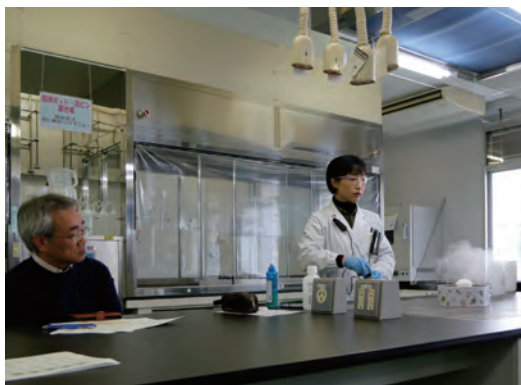
プッシュプル換気装置によるガスの捕捉
