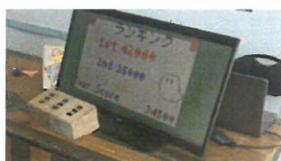
3x3に並べられたスイッチがゲーム画面中の部屋に対応。部屋に次々と現れる幽霊に対して、対応する電灯スイッチを操作して部屋の灯りを付けることで幽霊を撃退していくゲーム。
